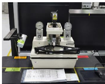
设备名称：切割机 设备用途：切割分粒
