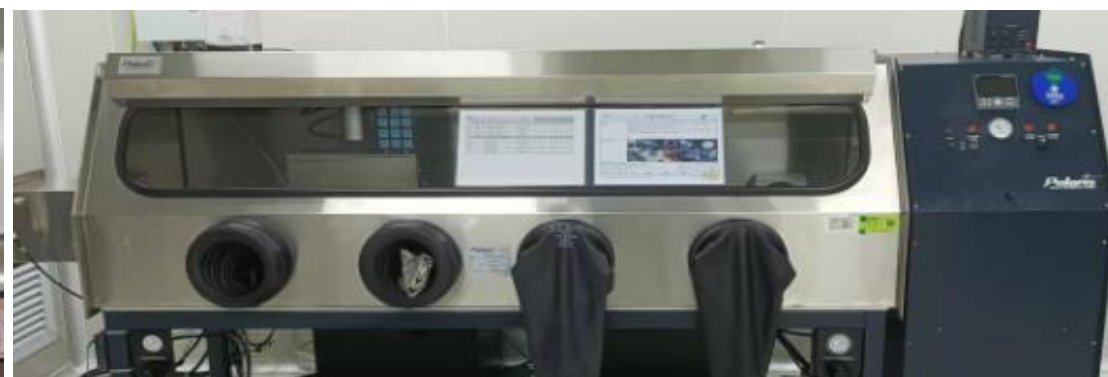
① 设备名称：封帽机 设备用途：TO管座同轴封帽
