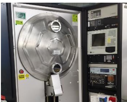
设备名称：蒸镀机 设备用途：多金属蒸镀
