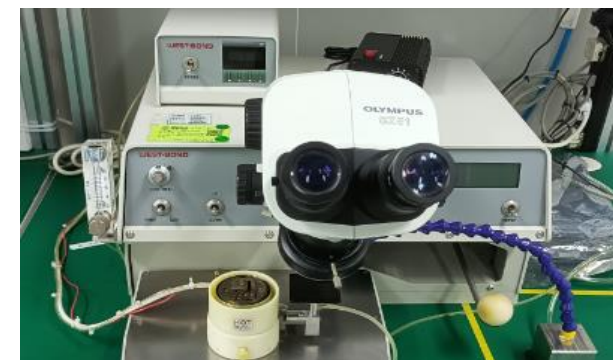
⑨ 设备名称：共晶机 设备用途：共晶贴片
