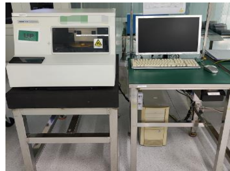
设备名称: 膜厚测试仪 设备用途: 测试厚度
