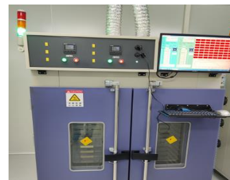
设备名称: TO46老化炉 设备用途: 接收器件老化测试
