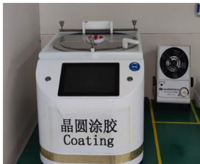
设备名称：晶圆涂胶机 设备用途：加胶
