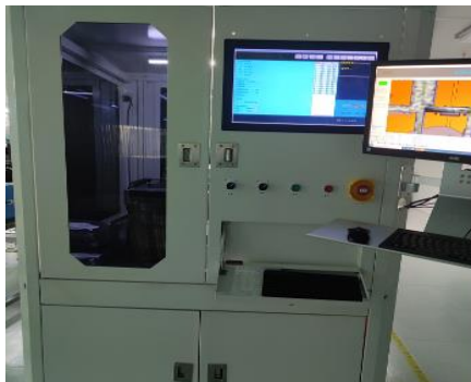
设备名称: AOI 设备用途: 自动外观检验
