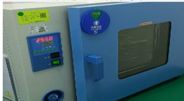
⑩ 设备名称：台式鼓风干燥箱 设备用途：胶水烘烤
