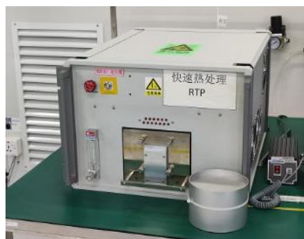
设备名称：合金化机 设备用途：快速热处理
