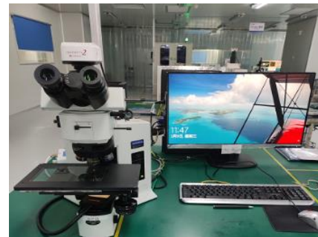
设备名称：高倍镜 设备用途：外观检验
