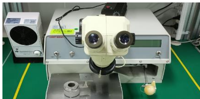
设备名称：固晶机 设备用途：环氧贴片
