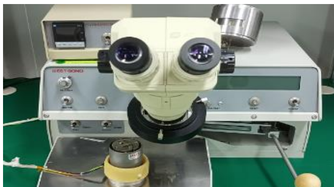
⑦ 设备名称：微机控制球键合机 设备用途：打金线
