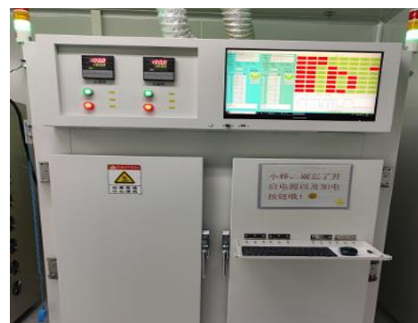
设备名称: TO56老化炉 设备用途: 发射器件老化测试
