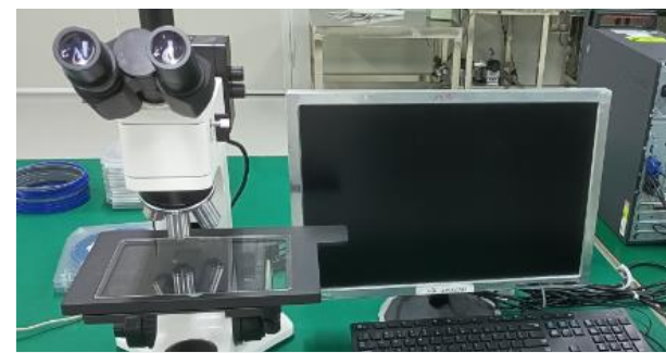
设备名称：金相显微镜 设备用途：芯片外观检查
